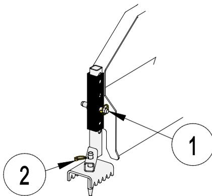
1. Auf dem Rahmen des Baggers und am Ausleger befinden sich mehrere Löcher. Drücken Sie den Einstellungsbolzen durch die entsprechenden Löcher und verwenden Sie den Splint, um den Einstellungsbolzen zu verriegeln.
